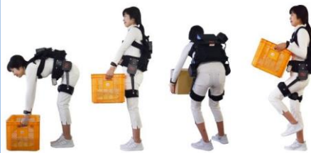
持ち上げ時 10~15kg分 腰のアシスト 持ち下げ時 ブレーキで 腰のアシスト 中腰作業時 姿勢保持で 腰のアシスト 歩行時 股関節 アシスト
