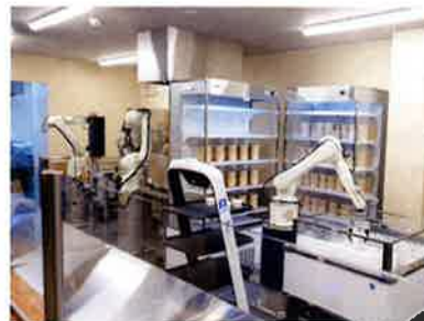
★ 産業用ロボットが調理して搬送ロボットへ
