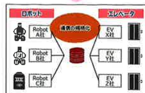
ロボットとエレベーター間の通信の規格化のイメージ（経産省資料から）
